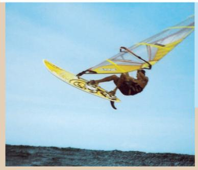
Una tavola wave, costruita in sandwich con fibre carbon/kevlar "high modulus", rigida e leggera, ben rifinita ed equipaggiata con una parte accessoristica di prim'ordine (straps e pads stellari associati ad una buona pinna) che vi farà "innamorare" al primo bordo....
